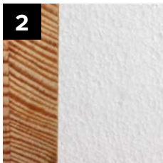
Wypełnienie spienionym polistyrenem EPS oraz ramiakiem z drewna klejonego.
